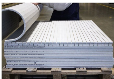
5 Pour les bandes de rive, rouler la plaque jusqu'au bout
